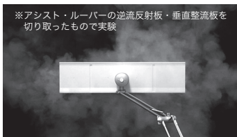
逆流や横漏れでエアコン付近にも空調風が拡散してしまいます。
